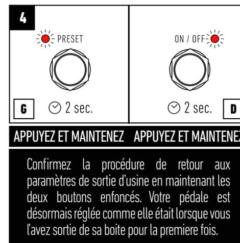
◀ Si l'utilisateur est entré par erreur dans cette procédure et souhaite en sortir sans restaurer les paramètres de sortie d'usine, il peut soit débrancher la pédale, soit suivre les étapes 1 à 2.
